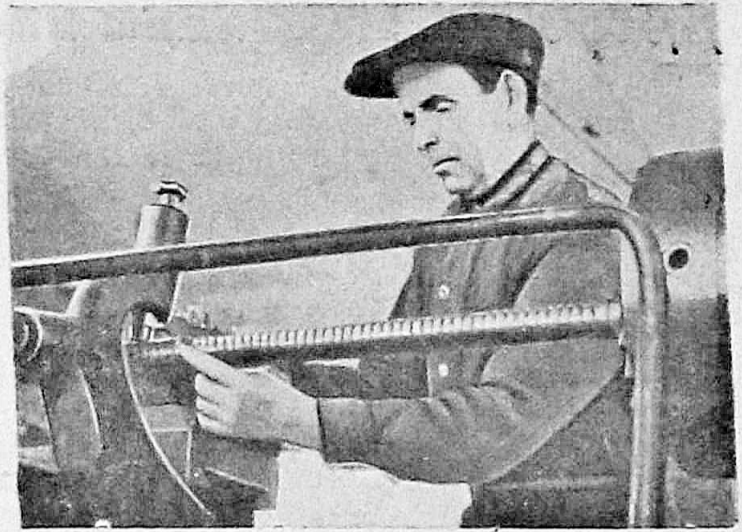
Токарь ремонтного завода управления сельского хозяйства Иосиф Иванович Ячменников в дни работы XX съезда КПСС добился высокой производительности труда, он выполняет по две нормы за смену. На снимке: токарь И. И. Ячменников обрабатывает новый ходовой винт для токарного станка.
